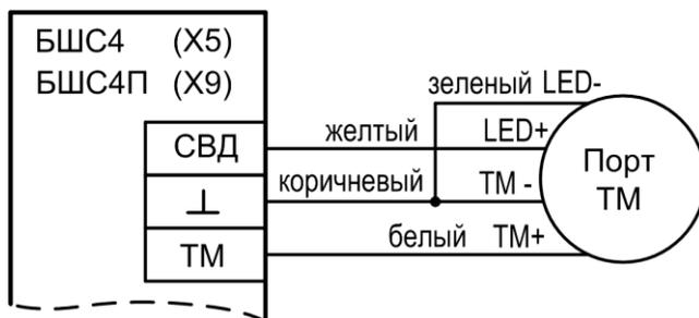
Рис.13 Схема подключения порта Touch Memory к БШС4 и БШС4П
