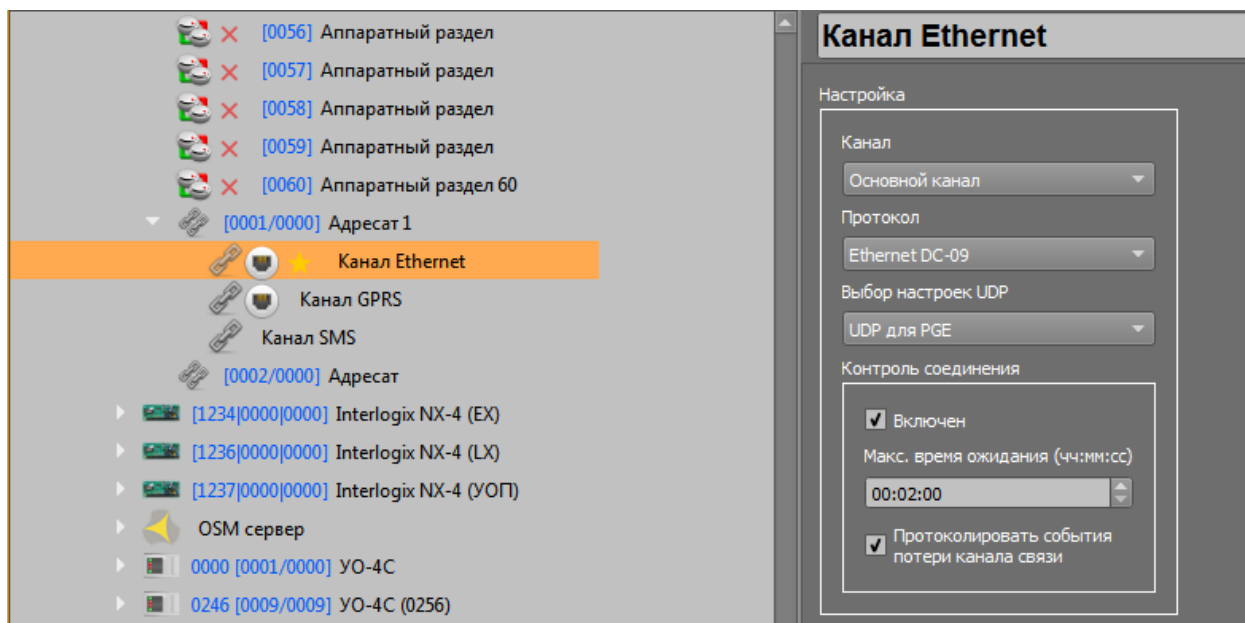
Рис.63 Пример настройки контроля связи основного и резервного каналов в C2000-PGE
