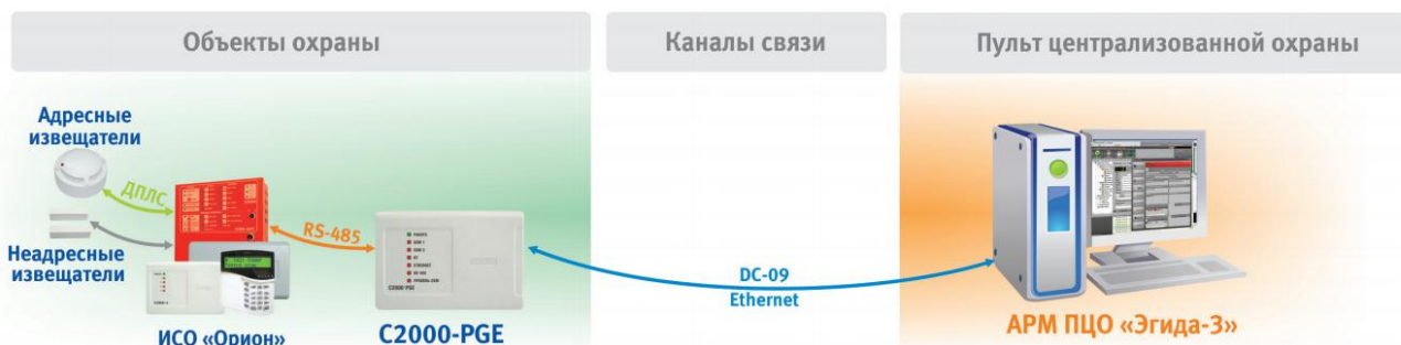
Рис. 4 Схема трансляции извещений от приборов ИСО «Орион» через C2000-PGE исп. 02 на АРМ ПЦО Эгида-3 по локальной сети
