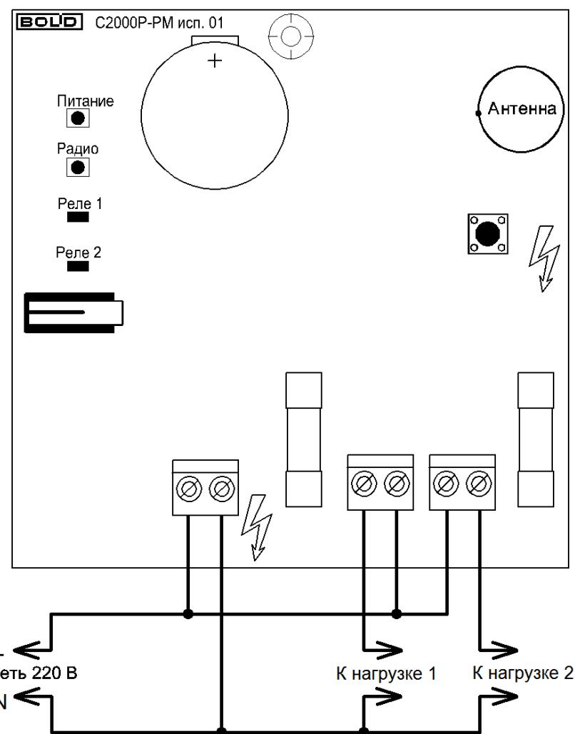
Рисунок 11.20 Схема внешних соединений, вариант подключения нагрузки C2000P-PM исп. 01
