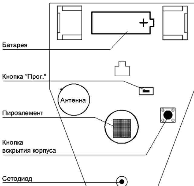
Рисунок 11.11 Расположение элементов
