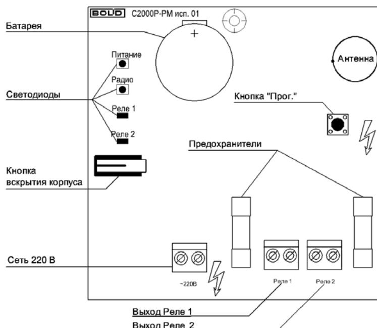
**Рисунок 11.18** Расположение элементов на плате
