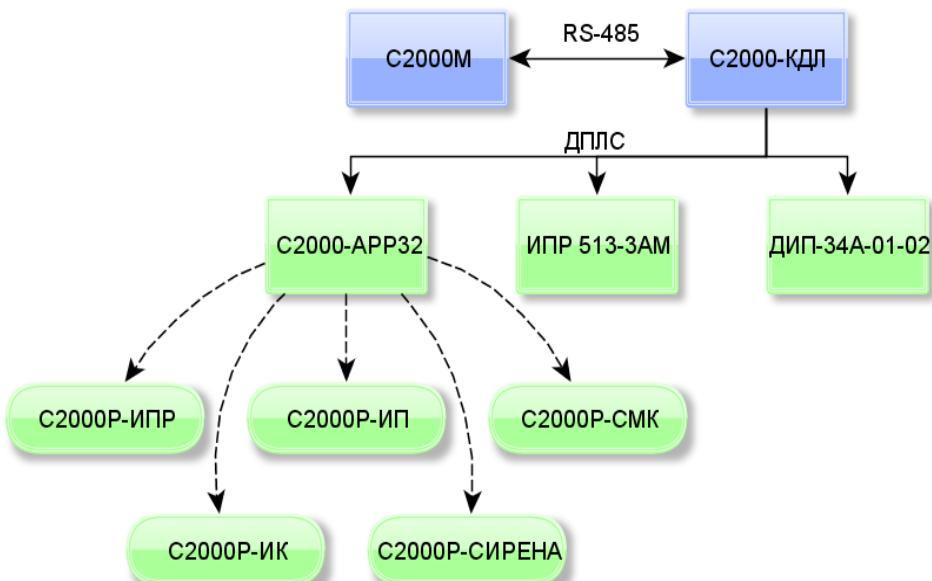
Рисунок 1.1 Блок-схема подключения адресных радиоканальных устройств
