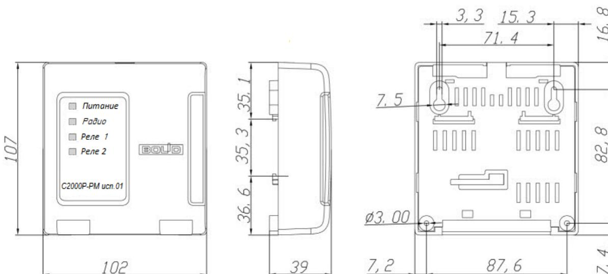
Рисунок 11.19 Габаритные и установочные размеры С2000Р-РМ исп. 01
