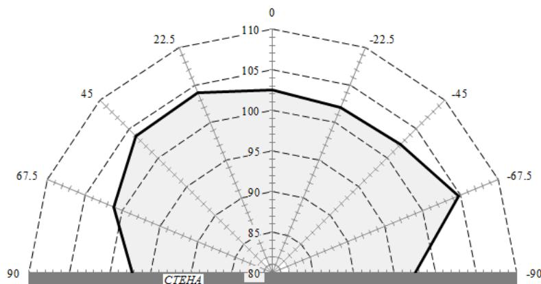
Рисунок 11.13 Диаграмма направленности звукового оповещения в горизонтальной плоскости, дБ
